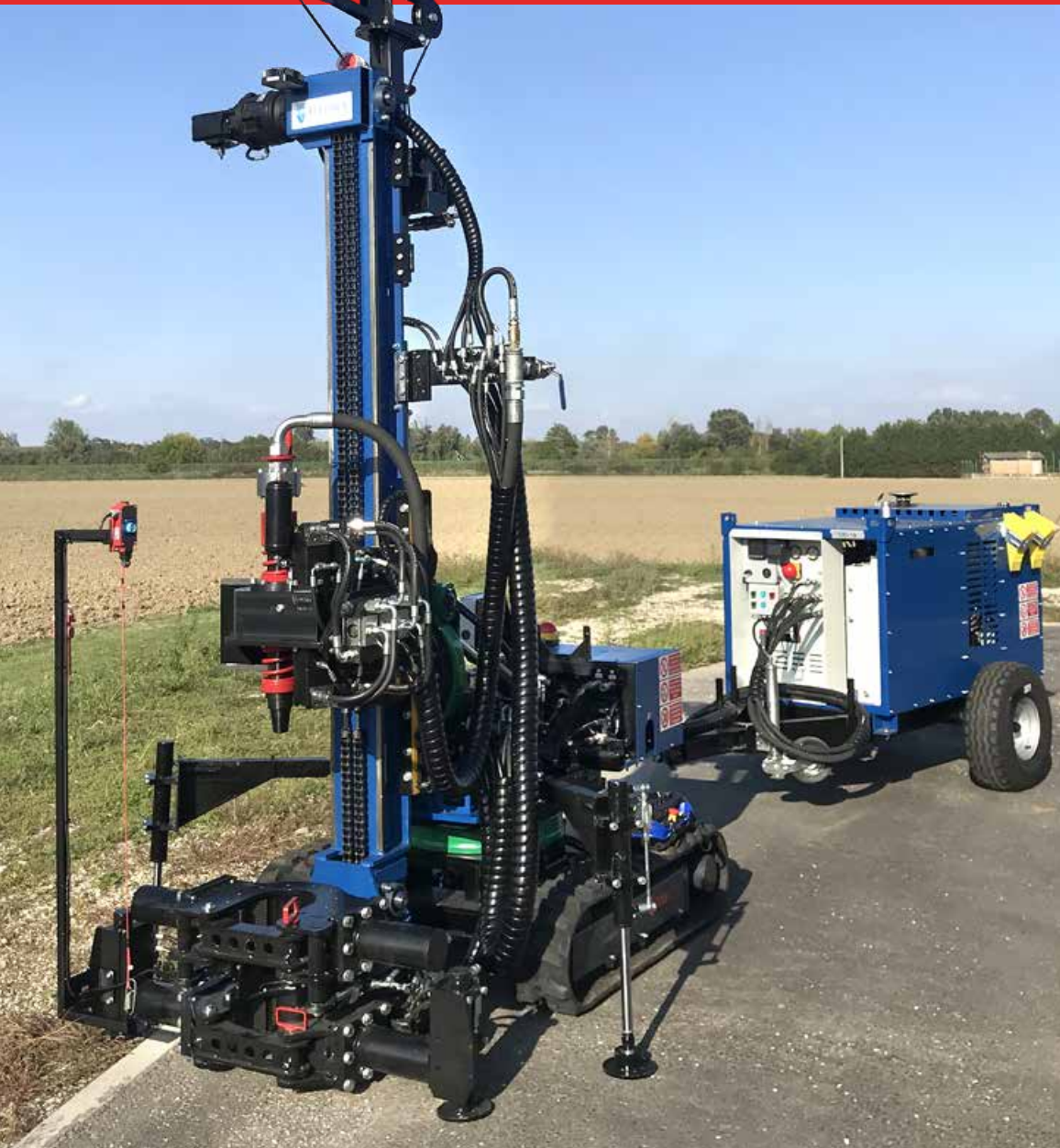
Perforatrice dotata di 8 movimenti (automatici e manuali) / Drilling machine equipped with 8 movements (automatic and manual) Perforatrice dotée de 8 mouvements (automatiques et manuels) / Mit 8 (automatischen und manuellen) Bewegungen ausgestattete Bohr
