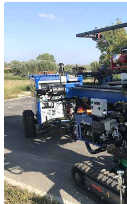
Perforatrice dotata di 8 movimenti (automatici e manuali) / Drilling machine equipped with 8 movements (automatic and manual) Perforatrice dotée de 8 mouvements (automatiques et manuels) / Mit 8 (automatischen und manuellen) Bewegungen ausgestattete Bohr
